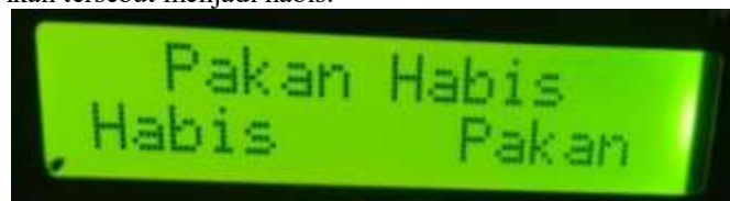
Gambar 21. Tampilan LCD saat sensor LDR terkena cahaya
