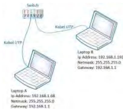
Gambar 7 Cara Kerja Pada Jalur UTP
