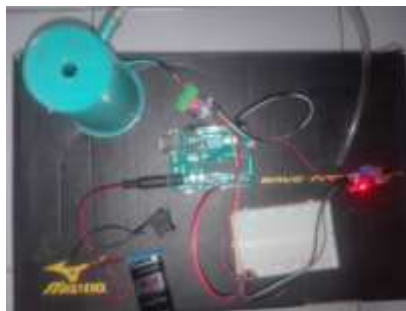
Gambar 3.6 Pengujian Motor Pompa Air Mini Dc
