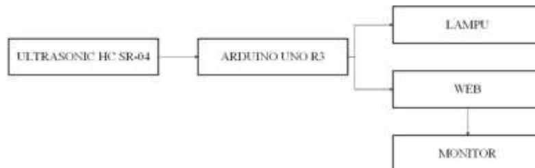
**Gambar 6. Diagram Blok Sistem Keseluruhan**
