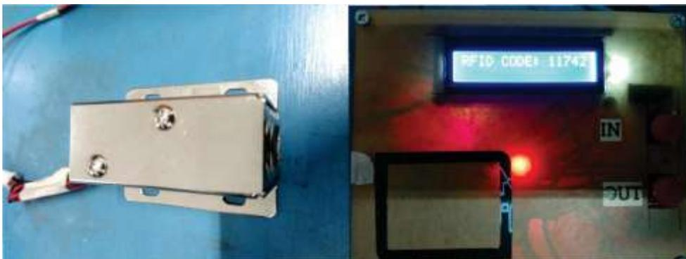
Gambar 8 Pengujian tag RFID untuk membuka solenoid
