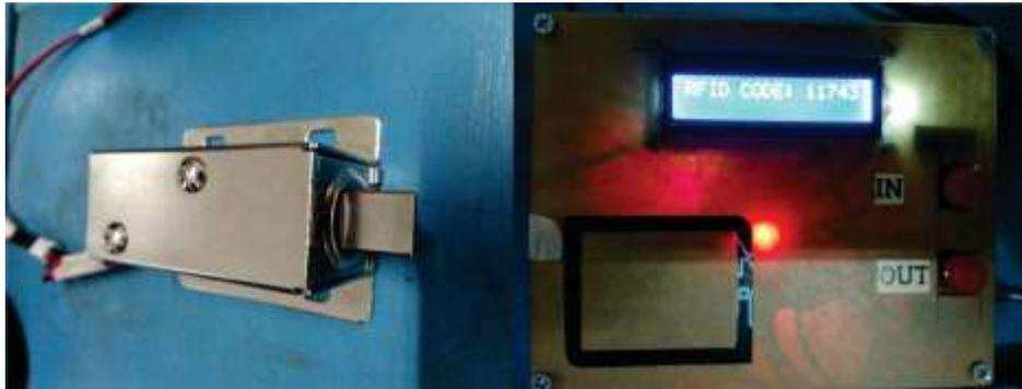
Gambar 10 Pengujian *Key Tag* dengan RFID *code* 11743
