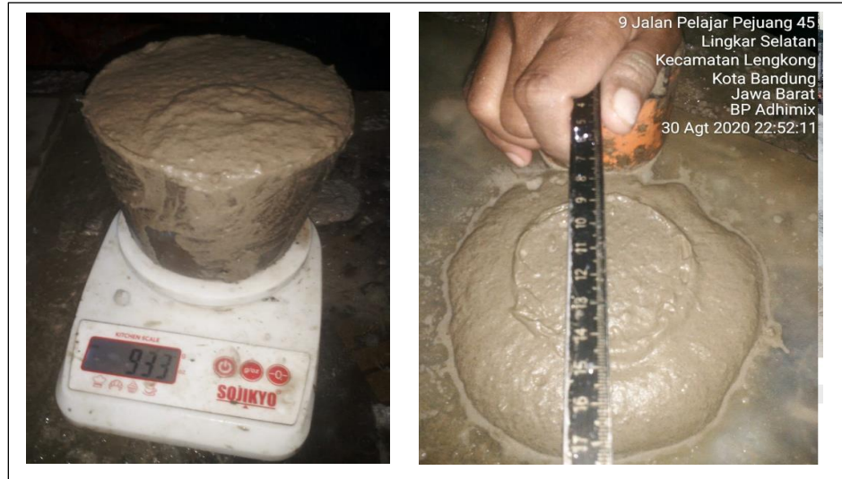
Gambar 1. Penujian Krucut Rawa Pada Beton LCC
