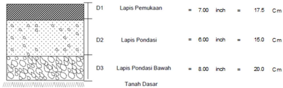
Gambar – 9: Susunan Lapisan Perkerasan Lentur
